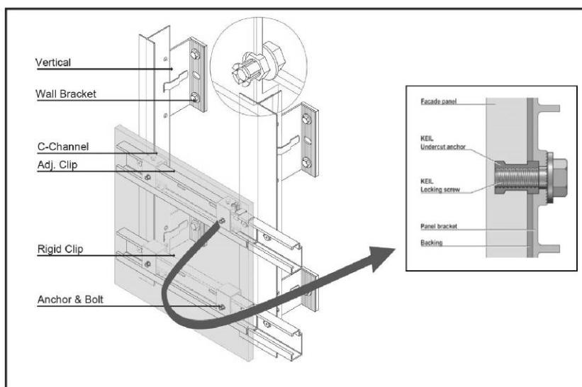
**Πίνακας 1: Συστήματα ανάρτησης αλουμινίου για πάνελ ινοπλισμένου σκυροδέματος και επιφάνειες εποπτικού υλικού επί δομικού στοιχείου του κτηρίου**
